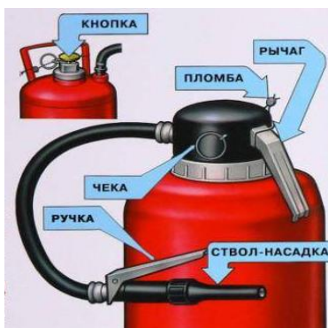
Рис 26. Порошковые огнетушители с газовым (газогенерирующим) источником давления
