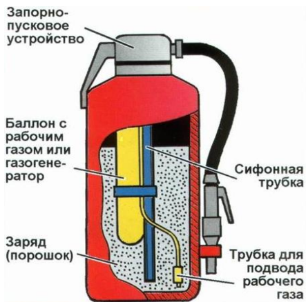
Рис.30. Порядок приведения порошкового огнетушителя с газовым источником давления или газогенератором
